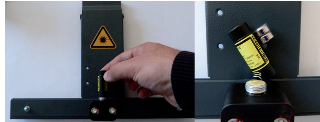
Fig. 17: Замена аккумуляторной батареи
