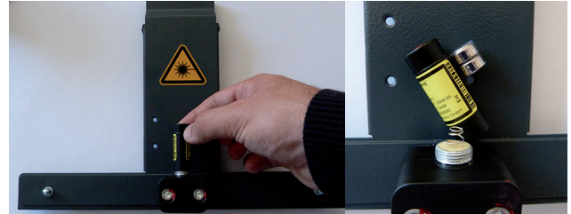
Fig. 16: Sostituzione delle batterie
