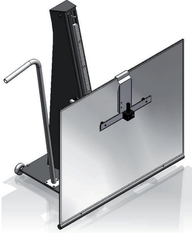
Şek. 15: Ayna üzerindeki lazer hizalama ünitesi
