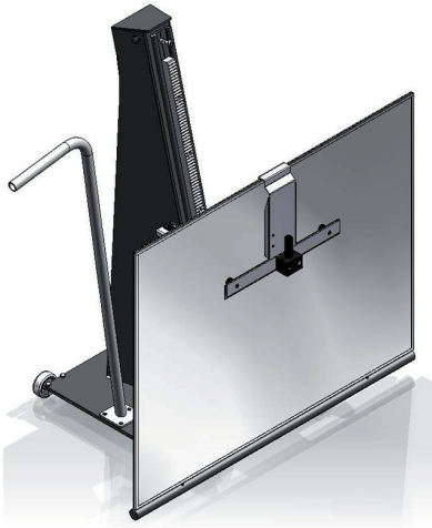
Afb. 15: Laseruitlijneenheid op spiegel
